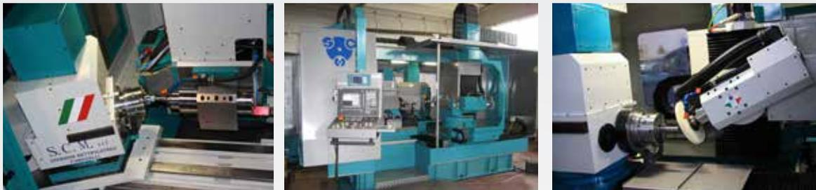
Oggi siamo specializzati nella costruzione di rettificatrici a banco fisso con motori lineari e la possibilità di eseguire operazioni di rettifiche esterna ed interna in maniera contemporanea e con un'unica presa pezzo.
